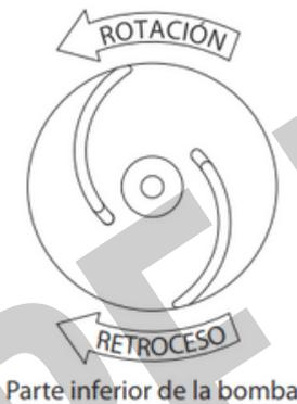
**PASO 3: El retroceso** debe ser siempre en sentido contrario a las manecillas del reloj, visto desde el motor, o contrario a la rotación del impulsor, la cual a su vez deberá ser contraria al sentido de giro de las manecillas del reloj, visto desde la base de la bomba
