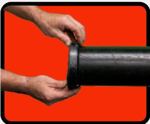
Inspeccione la ranura exterior y los extremos de la tubería para verificar que se hayan eliminado todas las rebabas, residuos sueltos, suciedad, virutas, pintura y cualquier otro material extraño, como grasa.
